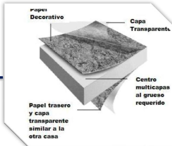
Designado por NEMA (Asociación Americana de Fabricantes Eléctricos) como un laminado plástico de alta presión bajo la categoría de laminado compacto superior a 2 mm de espesor (norma LD-3 2005).
